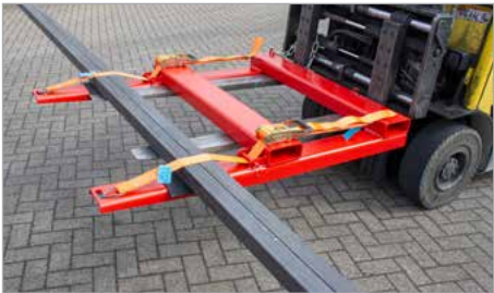
Position de préhension pour charger ou décharger
