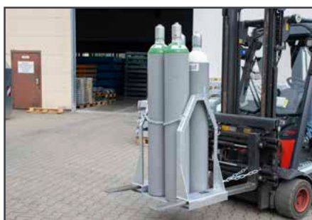
Manutention de bouteilles de gaz
